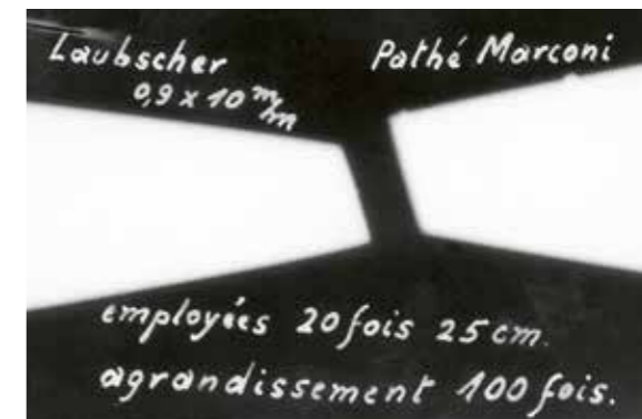
Mikrofotografie, Abnutzungsvergleich von Nadelspitzen
